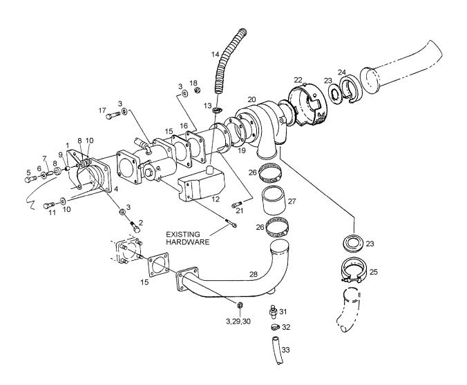
FIGURE 1. TURBOCHARGER INDUCTION SYSTEM
